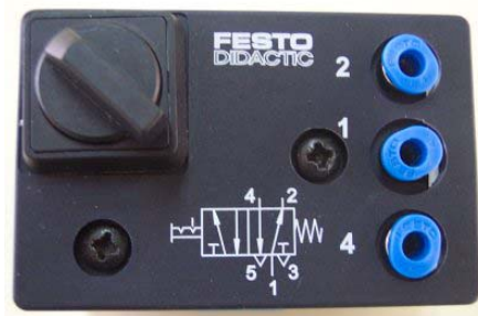
Foto de una válvula 5/2 activa manual, retorno por muelle
