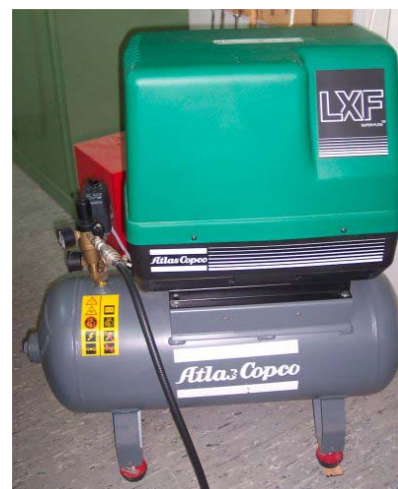
Compresor con su depósito
