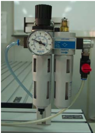
Foto de la unidad de mantenimiento
